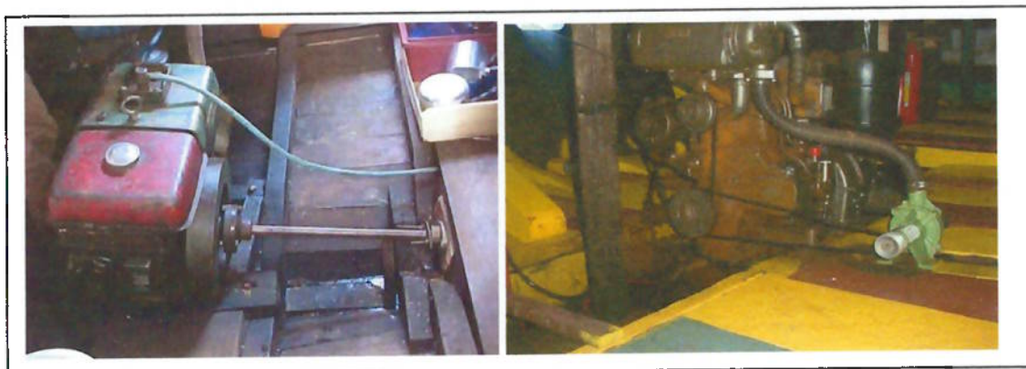
Figura 45 - Exemplo de partes móveis expostas em embarcações
